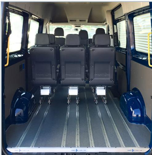
Der Smartfloor Aluminium-Systemboden ermöglicht eine flexible Nutzung des Fahrzeuges.
