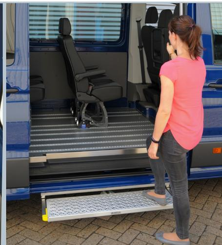
Die elektrische Trittstufe ermöglicht einen bequemen Seiteneinstieg.
